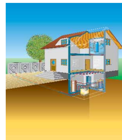
Heizkraft aus Sonnenwärme: In den Massivabsorbern aus Beton wird Sonnenwärme in eine Wärmeträger-Flüssigkeit überführt.
