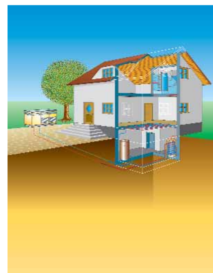
Heizkraft aus der Luft: Ventilatoren führen die Luft am Verdampfer der Wärmepumpe vorbei. Dabei wird ihr Wärme entzogen.
